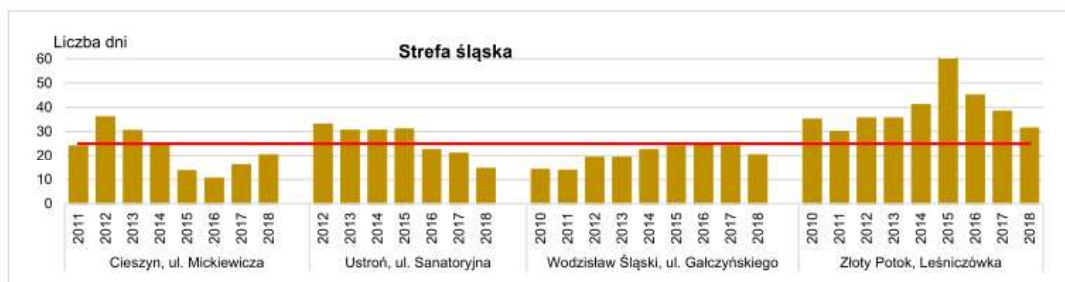
Rysunek 6 Liczba dni w latach 2010-2018 w strefie śląskiej, w których najwyższa ośmiogodzinna średnia krocząca stężenie ozonu przekraczała 120 \mu\text{g}/\text{m}^3
